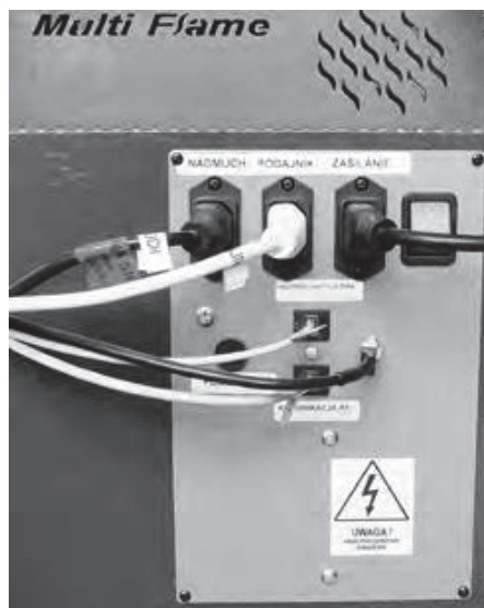
Obrázek 3 Řídicí modul hořáku.
