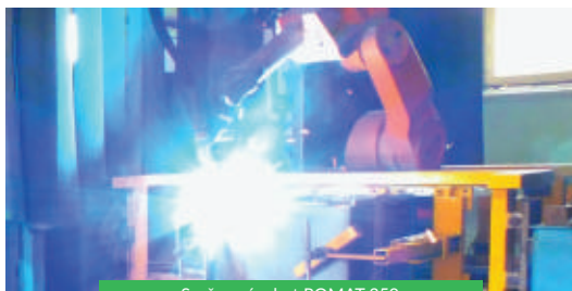
Svařovací robot ROMAT 350
