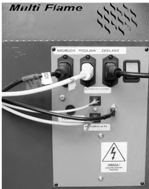
Obrázek 3 Řídicí modul hořáku.
